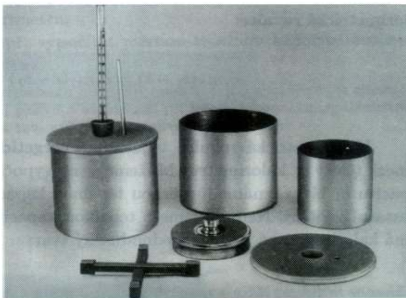
Směšovací kalorimetr (schéma a jednotlivé části)
